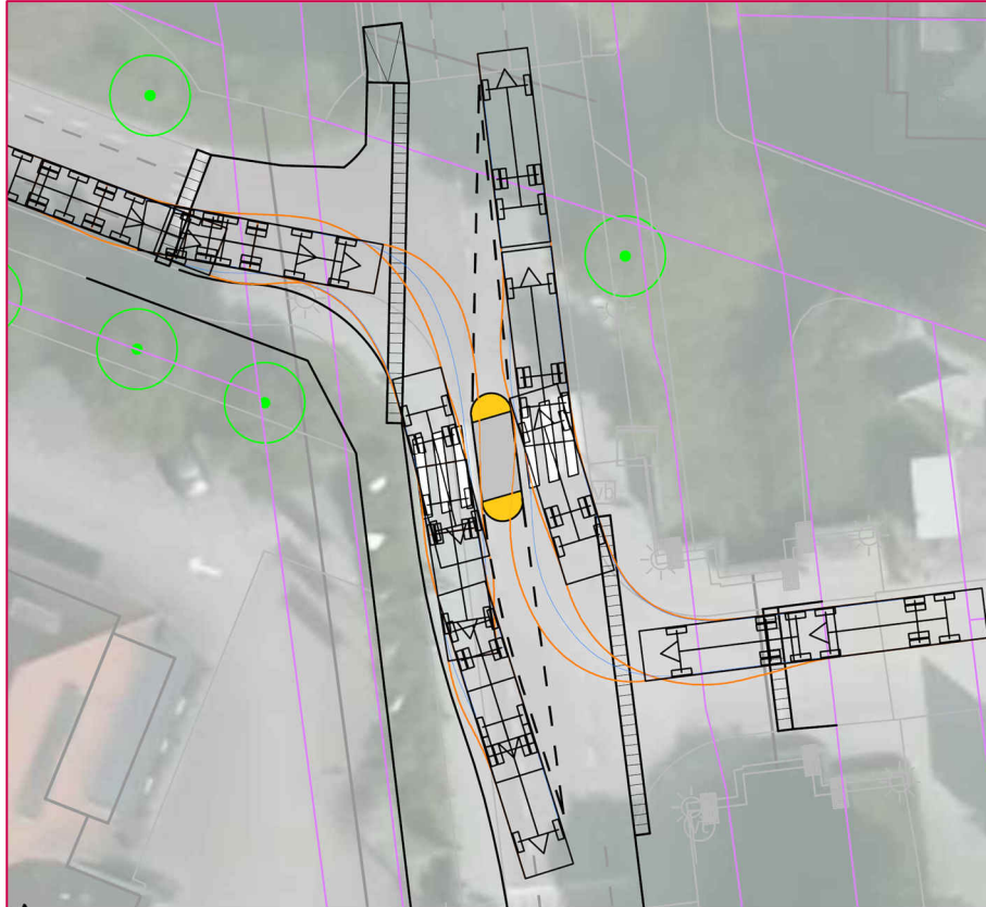
Figuur 5.2: middeneiland met de rijcurve van een vrachtauto (vuilniswagen)
