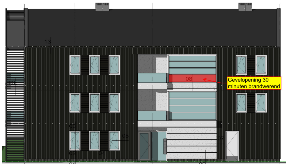
Noordoostgevel met brandwerend glas app. 10
