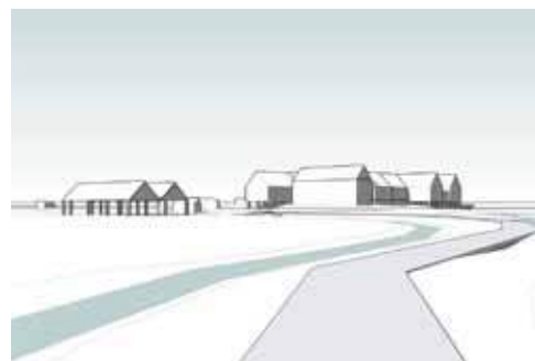
Variant 3 Parkeerschuur met dubbele kap > dakvlak ietwat kleiner, ca 120 m 2 op de zon > voordeel is een lager gebouw
