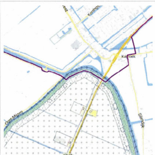
Afbeelding 1b: Uitsnede noordzijde plangebied voorontwerp met locatie van de 50 kV kabel (roze lijn)
